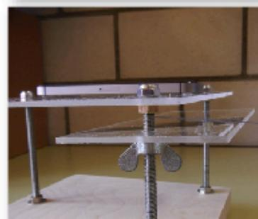
Maximale mögliche Vergrösserung ca. 35x (Die maximale Vergrösserung hängt von der verwendeten Linse und dem Zoomfaktor der Smartphone-Kamera ab)
